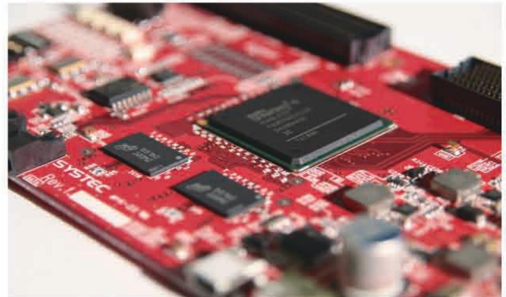
SY-S6-01 はザイリンクス社製 低コスト FPGA Spartan6 「XC6SLX75T-2FGG676」を搭載したPCIExpress ボードです。高速アクセス可能な複数の I/F を設ける事により機能拡張性を高め、様々な外部機器と接続し機能拡充する事が可能です。更に SSD を搭載する事により大容量データの格納が可能です。
